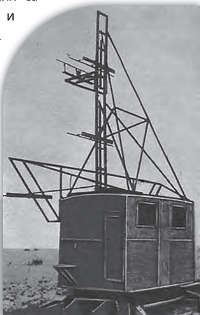
Станция орудийной наводки СОН-20т – излучающая установка
