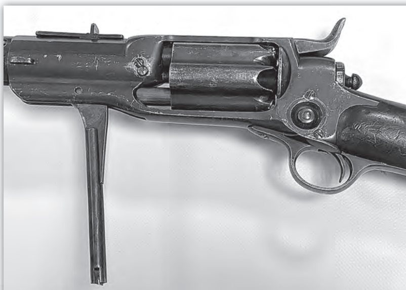
Каморы барабана винтовки заряжались специальным рычагом. На фото: рычаг в положении заряжания
